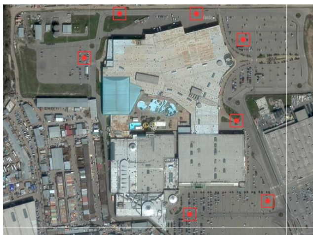
Рисунок 14 - Точки установки тахеометра
